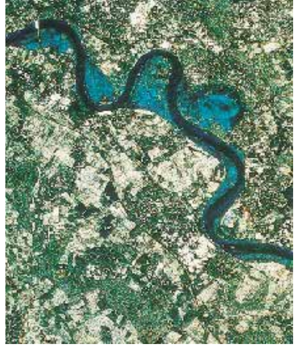
Auf diesem Bild des Rheins bei Dormagen lassen sich Hochwassergebiete (hellblau) deutlich vom normalen Flusslauf (dunkelblau) unterscheiden. Um sie sichtbar zu machen, wurden drei Radarbilder desselben Gebietes am Computer „übereinandergelegt“. Sie wurden am 31. Januar und 25. Dezember 1993 sowie am 3. Januar 1994 vom Radarsatelliten ERS-1 aufgenommen.
